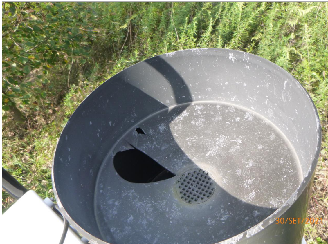
Foto 4: dettaglio rottura pluviometro
